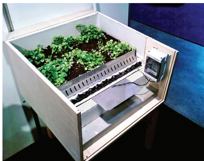
Model zelené střechy s hydroizpací z Rhepanolu hg a kontrolním systémem ProtectSys
