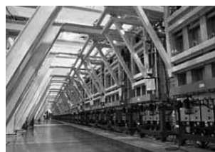
▲ Obrázek 54 ▲ Výrobní linka na amorfní křemík roll-to-roll
